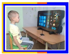
Оборудование предназначено для детей от 4 до 10 лет, представляет собой монитор с видеокамерой, колонками, микрофоном. «Умное зеркало» совмещает в себе роль обычного и интерактивного зеркала.
